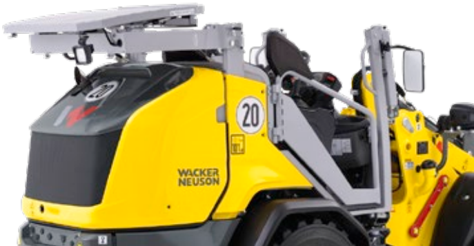
Rápidamente abatible: techo de protección para el operador EPS (Easy Protection System).
