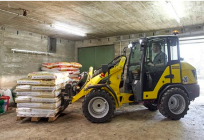
Dimensiones compactas: ideales cuando todo depende de unos centímetros. La WL250 destaca por su diseño de perfil bajo, lo que le permite superar sin problemas alturas de paso inferiores a 2 m.
