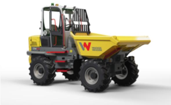
El dumper sobre ruedas tiene todo lo que necesita una máquina potente: tracción hidrostática a las cuatro ruedas con modo ECO automático, y caja de volteo giratoria y caja frontal con una carga útil de 6.000kg. Con la cabina de seguridad moderna y fácilmente desmontable (opcional), puede usar el dumper durante todo el año en cualquier clima.
