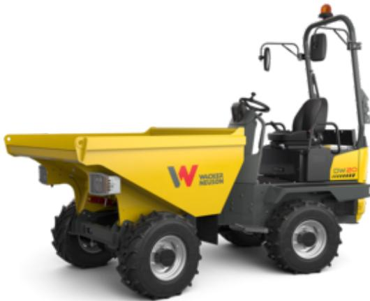
El DW20 impresiona con un gran número de características de seguridad y su elevado confort. Gracias a la caja de volteo giratoria en altura recientemente desarrollada, junto con el sensor de inclinación completamente fiable, el dumper sobre ruedas es seguro y versátil.
